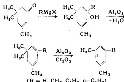
**Die Aromatisierung** wird durch ein Gemisch von aktivem Al- und Cr-Oxyd katalysiert. Dabei wird stets eine der geminalen Methyl-Gruppen mit einem H des benachbarten C-Atoms als Methan abgespalten („Demethanierung“). Durch die gleiche Reaktion kommt man vom Dihydroisophorol zum m-Xylo (R = H). Das Verfahren ist für kleine und große Ansätze geeignet und liefert bei guten Ausbeuten Aromaten von hoher Reinheit. (J. org. Chemistry 19, 922 [1954]). —Be. (Rd 309)
